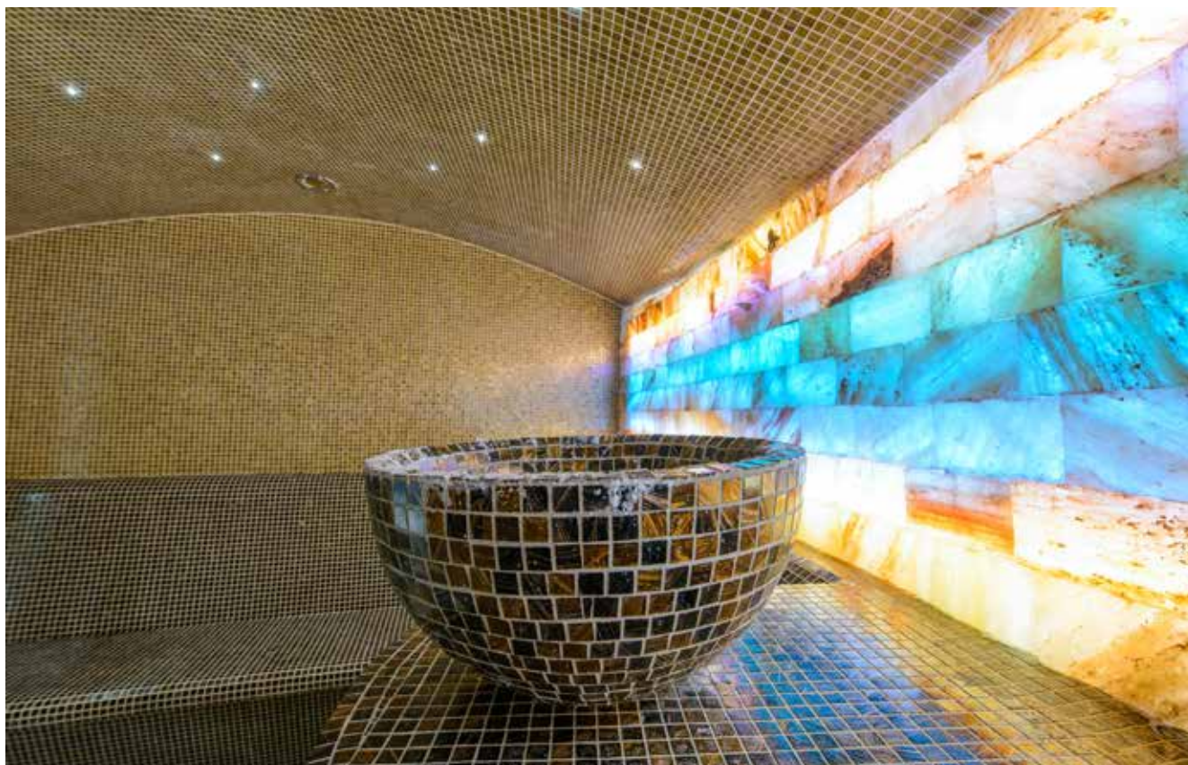
Mit den Spa Modulen von Harvia lassen sich komplette Wellness-Bereiche kreieren. Diese umfassen Wand-, Dach-, Sitz- und weitere Teile als montagefertige Bauteile, die wasserdicht grundiert und dann gefliest werden ( www.harvia.de ). Rechts: Dampfgenerator von osf Hansjürgen Meier. ( www.osf.de )
