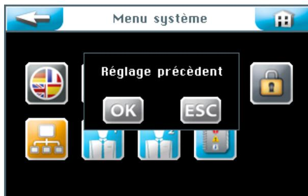
Confirmez votre sélection par **OK** pour que le logiciel soit réinitialisé sur la configuration d'origine ou annulez l'opération avec **ESC**.
