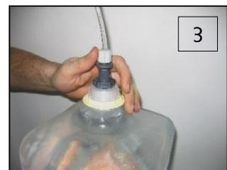
5. Retournez complètement le contenant raccordé et glissez-le dans la console. Il convient de veiller à ce que la bride annulaire jaune soit correctement insérée au niveau de l'élément de guidage prévu à cet effet.
