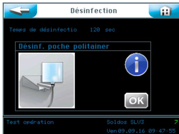
3. Raccordez la poche politainer remplie de solution désinfectante et la mettre en place sur la console selon la description du paragraphe suivant.
