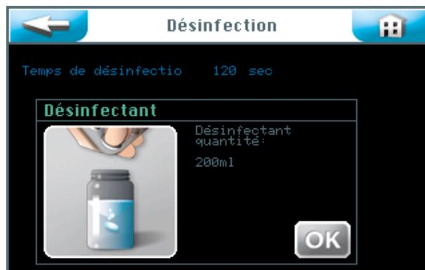
2. Remplissez d'eau le flacon vide livré avec le kit de désinfection (20). La quantité de solution désinfectante nécessaire dépend de la longueur de la conduite de
