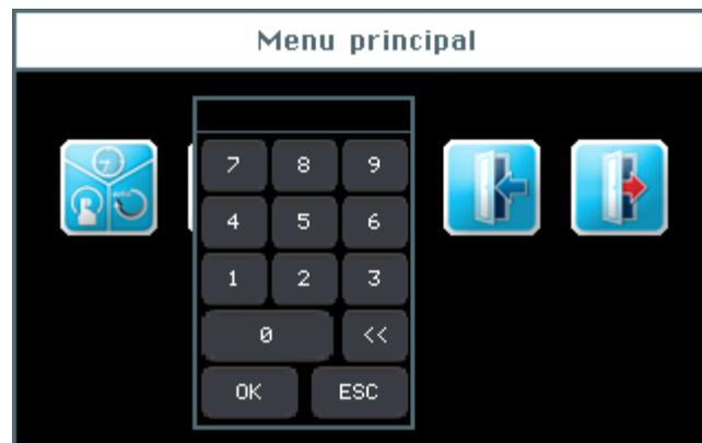
La configuration de la commande est liée à divers niveaux d'utilisateurs – de 0 à 7.
