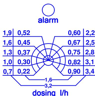
**Achtung ! Nur die Skala des eingelegten Schlauches verwenden. Werte entsprechen Dosierleistung in ml pro Stunde!**
